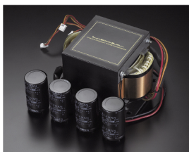
大容量パーツによる電源ブロック
