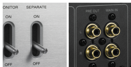
セパレートスイッチと対応する背面端子
