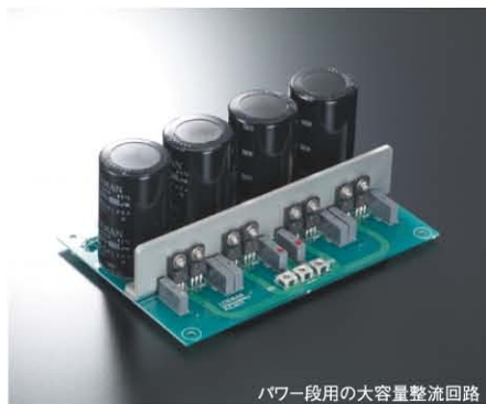
パワー段用の大容量整流回路
