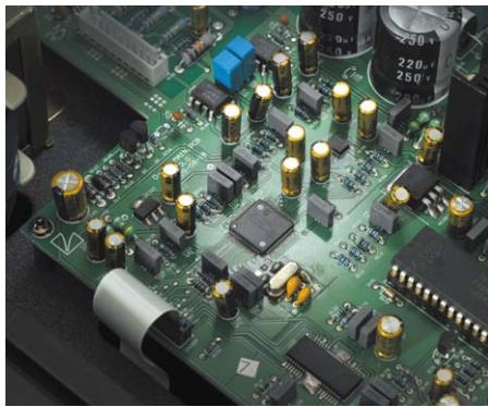
高音質の音楽データをアナログに変換するDAC周辺回路
