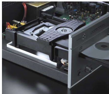
極厚のアルミベースに固定された高信頼ドライブメカ
