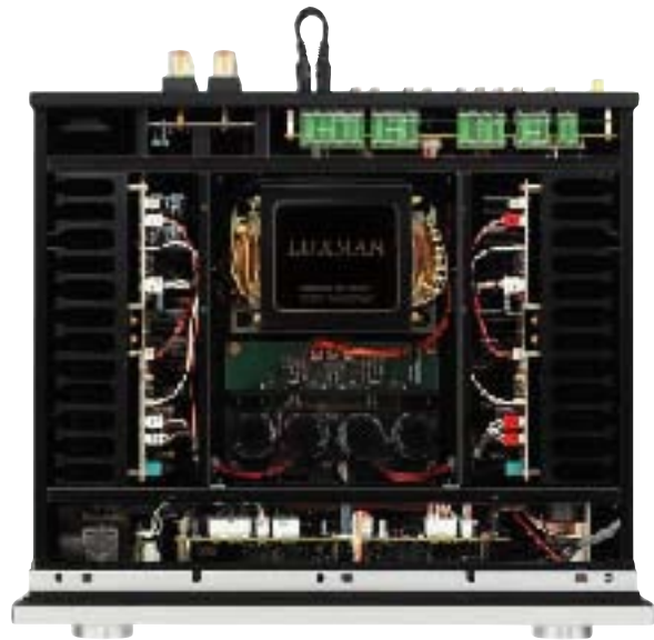
制振性を高めた内部コンストラクション
