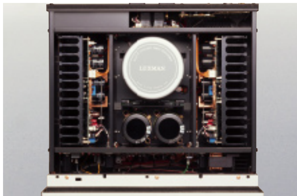
ボックス構造を採用した内部構成
