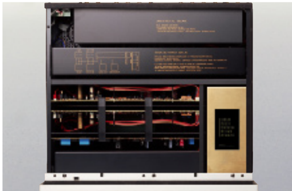
各ブロック毎に分割させた完全独立コンストラクション
