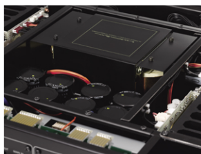
大容量パーツによる電源部
