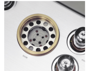
フローティング構造の出力管ソケット
