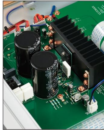
NT-07には、ラックスマンのさまざまなオーディオコンポーネント同様、音質を最優先したアプローチによる回路設計が施されています。電源部には、大容量のO1型パワートランスと、10,000μF×2本で構成されたカスタム仕様のブロックコンデンサーを搭載。高いノイズ圧縮率と安定感を誇る伝統のハイナイナージヤ（高慣性）電源回路を構築しました。また、高剛性シャーシで構成された薄型筐体は、フロントパネルにラックスマン製品共通のデザインモチーフである精緻なブラスターホワイト仕上げを施し、既存のオーディオシステムに組み込みやすい上品かつシンプルな外観を実現しました。
