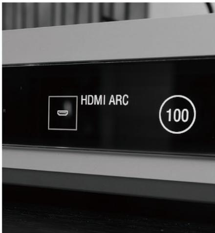
ここではテレビとNT-07を組み合わせた音質アップ方法を解説しよう。前提となるのが、ARC対応のHDMI端子を搭載したテレビを利用することだ(古いテレビだと非搭載の場合もあるので、必ず確認されたい)。接続は簡単で、テレビのHDMI端子 (ARCと表記されている) とNT-07のHDMI出力端子をARC対応のHDMIケーブルで結べば良い。これだけで、テレビの放送波やテレビに接続したBlu-rayプレーヤーなどの音声を、NT-07で受け取りオーディオ機器から音を出すことができる。
