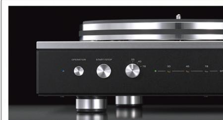
PD-151 MARK IIは、製品内部の重量パーツを独自のアンダースラング（吊り下げ）方式でメインシャフトとなる10mm厚のアルミ製トップパネルの裏側に取り付け、剛性と制振性の両立に成功。下部の箱型シャフトとトップパネルによる栈（さん）で微小振動を制御するフレームワーク構造を採用しました。
