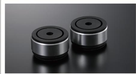
レコードに刻まれた微細な溝をトレースするアナログプレーヤーにとって、製品全体を支えるインシュレーターレッグは重要なパーツです。PD-151 MARK IIは、最大5mmまでの高さ調節も可能なオリジナル設計のインシュレーターに、温度特性や経年変化に優れた制振ゴムを組み込み、ハウリングや外部振動の伝達を防止しています。
