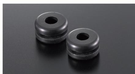
極小レベルのアナログ信号を正確にピックアップし、次段コンポーネントとなるアンプまで変質させることなく送りだすため、不要な振動は徹底的に抑え込む必要があります。PD-151 MARK IIでは、振動の発生源となるドライブモーターや電源トランスを特殊な制振ゴムでフローティングし、伝送される信号を高品質に保っています。
