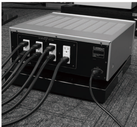
試験システムの電源を配線したES-1200のリアパネル
