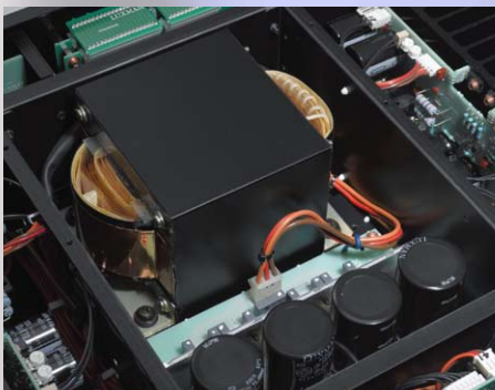
EI型トランスで構成された大容量電源ブロック
