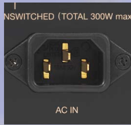
非磁性処理の施されたACインレット
