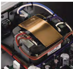
大容量電源トランス
