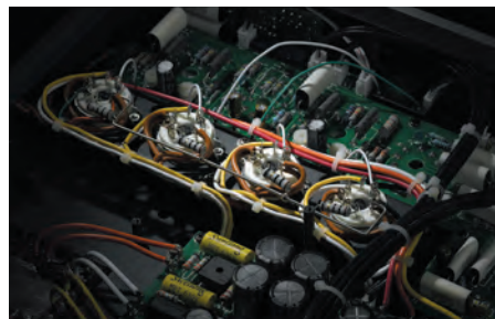
高品質なオーディオパーツを多用した内部基板
